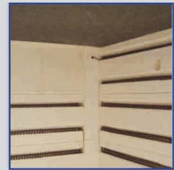
R-SIC Deckenplatte gegen Befall des Brennnguts von der Decke herab R-SIC cover sheet against infestation of the ware from the cover
