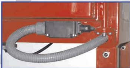
Geprüfter Sicherheitstürschalter - zwangstrennend Approved safety door switch - compulsory-separating
