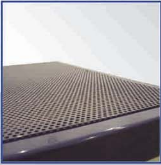
Lochblech auf dem Ofen gegen Hitze und Feuchtigkeit Perforated plate on the kiln against heat and moisture
