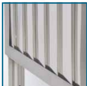
Extrem niedrige Außentemperatur durch Lamellenblech mit Hinterlüftung - kein Kondenswasser-Niederschlag in der Isolierung
