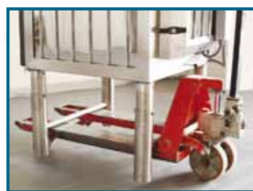
Untergestell mit Querstrebe für leichten Transport mittels Hubwagen Underframe with across-brace for the easy transport with fork-lift
